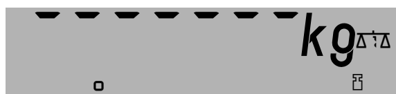
Abb. 26 Hauptanzeige zeigt Überlast an
