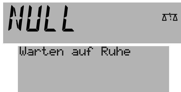
Abb. 18 Wägebrücke wird nullgestellt
