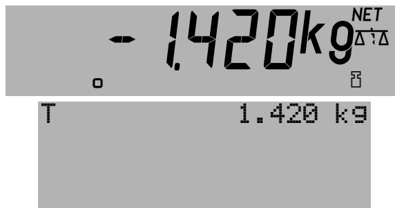
Abb. 32 Taraausgleich T von 1,42 kg bei unbelasteter Wägeplattform
