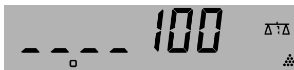
Abb. 35 Hauptanzeige zeigt zu kleines Referenzgewicht durch vorangestellte Unterstriche an
